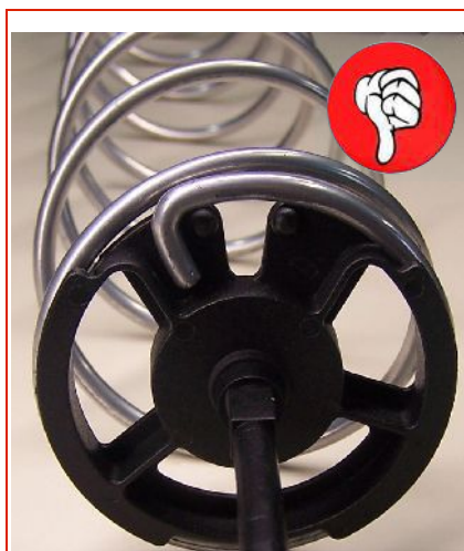
Spirale destra: montaggio errato
