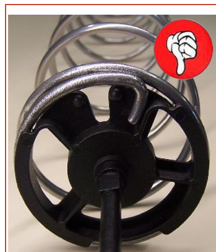
Spirale sinistra: montaggio errato
