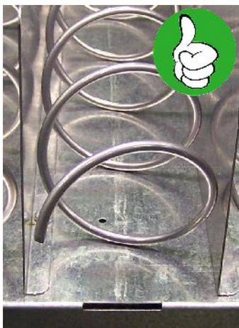
*Fig. 7: molla montata correttamente*
