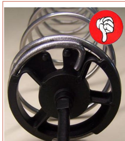
Fig. 22: Spirale sinistra montaggio errato
