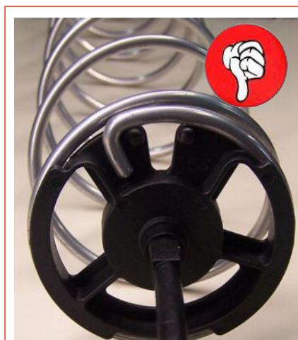
Fig. 21: Spirale destra montaggio errato
