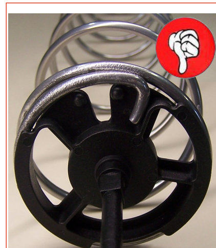
Fig. 22: Spirale sinistra montaggio errato
