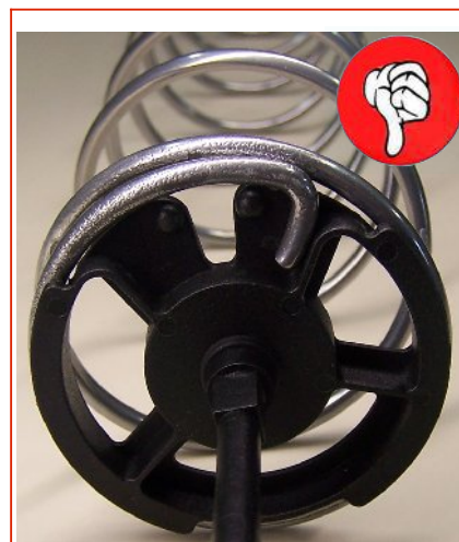
Spirale sinistra: montaggio errato
