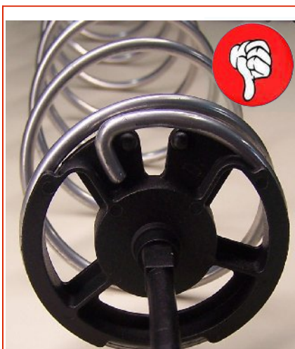
Spirale destra: montaggio errato
